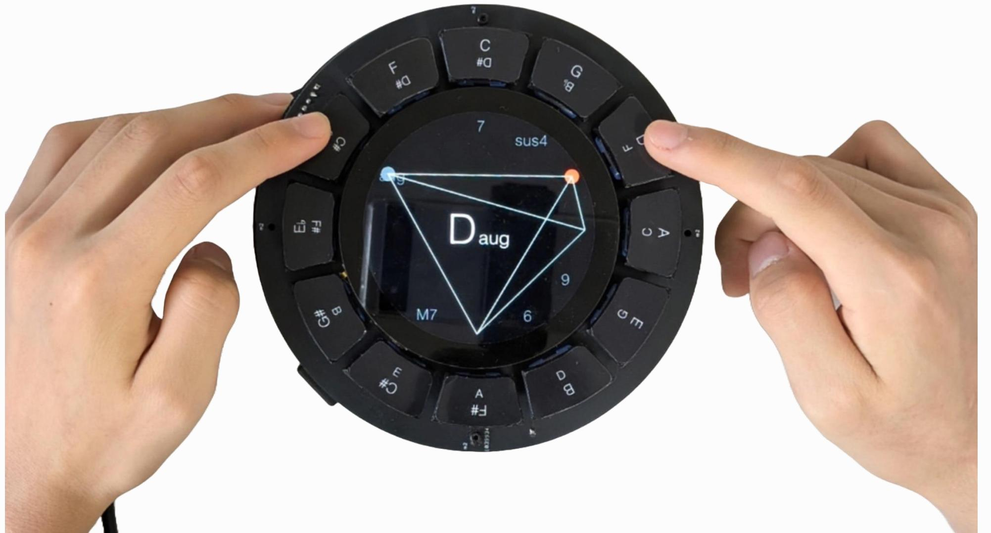
五度圏の順にキーを12個円形配置し、入力された情報を表示するディスプレイを搭載したハード・ソフト一体型の楽器「CycleTone」を開発
